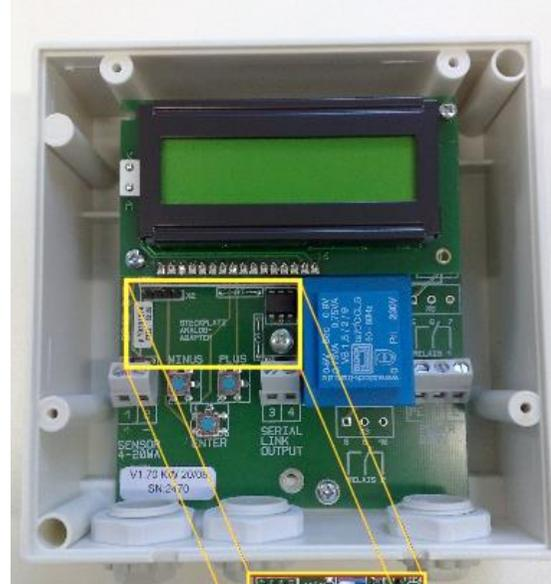
Den Adapter auf die 4-polige Kontakt-Steckleiste aufstecken und mit der M3-Schraube fixieren.
