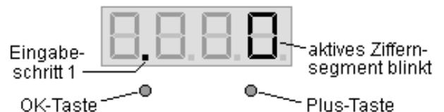
Die Eingaben erfolgen über die 2 Bedientasten **OK** und **Plus**. Mit der **Plus-Taste (rechts)** wird die aktive, blinkende Ziffer erhöht, mit der **OK-Taste (links)** wird deren Ziffernwert übernommen.
