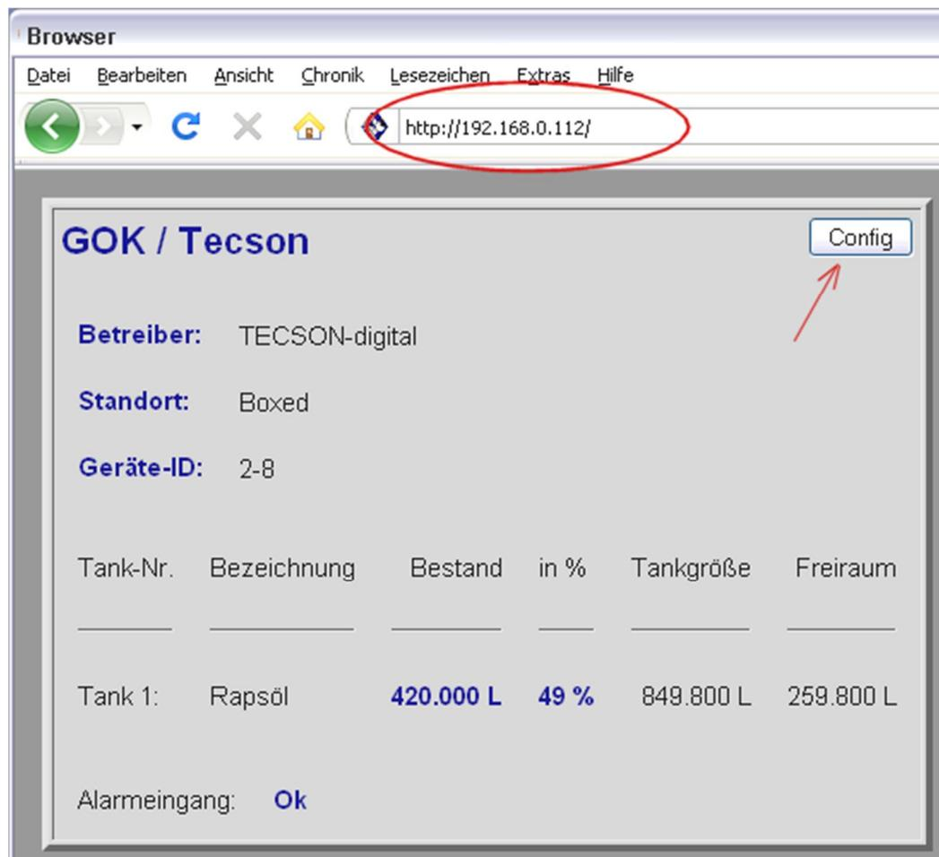
Über die ConfigSchaltfläche und die Passwordeingabe ( Standardpasswort = tank ) gelangen Sie auf die html-Seite %onfiguration%
