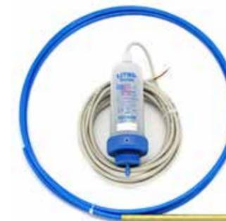
LITRO-Sonde und Messschlauch
