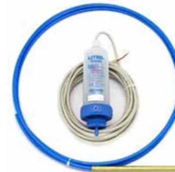
LITRO-Sonde und Messschlauch
