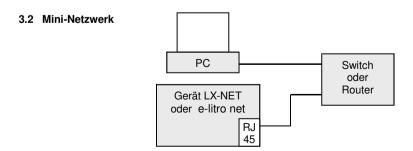
PC/Laptop über Switch oder Router mit der Gerätebuchse verbinden:
