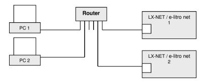
PC und Anzeigegerät sind an einem lokalen Netzwerk (LAN / Intranet ) direkt angeschlossen. Voraussetzung ist jeweils, dass das Anzeigegerät und der PC sich im gleichen Netzwerksegment befinden oder sich über entsprechende Router "sehen" können.
